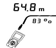
Figura 9.2 Determinación de NVP actual del cable
