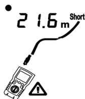
Rysunek 6.16 Zwarcie na okablowaniu koncentrycznym
