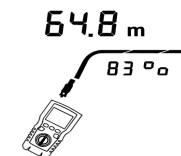
Rysunek 9.2 Określanie rzeczywistej NVP kabla
