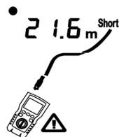
Abbildung 6.16 Kurzschluss auf Koaxialkabel
