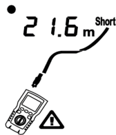
Figura 6.16 Corto en cableado coaxial
