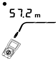
Figura 6.15 Abierto en cableado coaxial
