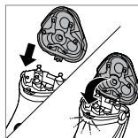
11. Setzen Sie den Ansatz des Rasierkopfes in den Schlitz in der Oberseite des Gerätes ein.
