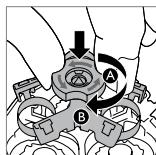
10. Setzen Sie den Halterahmen wieder in den Rasierkopf und drehen den Halterahmen im Uhrzeigersinn
