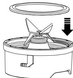
3. Montage der Klingeneinheit in den Mixbecher – setzen Sie den Mixbecher über die Klingeneinheit und drehen ihn im Uhrzeigersinn bis er einrastet.
