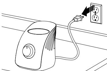
4. Po zakončení práce vypněte zařízení a odpojte jej od síťového napájení. Otočte nádobu proti směru hodinových ručiček a vyjměte ji z jednotky motoru.
