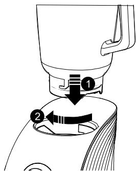
5. Setzen Sie Deckel und Messbecher auf den Mixbecher.
