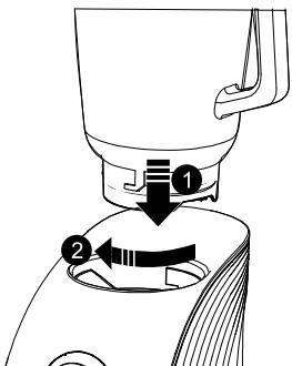
4. Umístěte nádobu na jednotku motoru a otočte ji ve směru hodinových ručiček, dokud nezaklapne.
