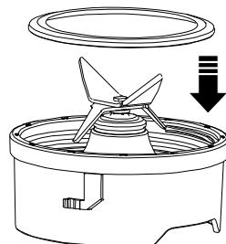
3. Τοποθετήστε το συγκρότημα λεπίδας στο δοχείο - τοποθετήστε το δοχείο πάνω από τη διάταξη λεπίδας και γυρίστε προς τα δεξιά μέχρι να ασφαλιστεί.
