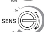
Bewegung wird im Bereich vom Gerät bis maximal 5 bis 8 Meter erkannt.
