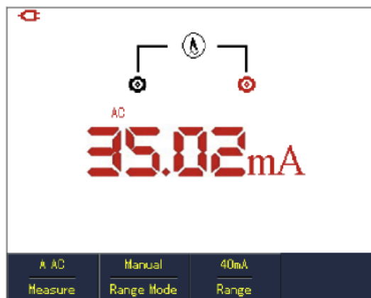
Rys. 5-18 Pomiar natężenia prądu zmiennego AC od 1 mA~ 40 mA
