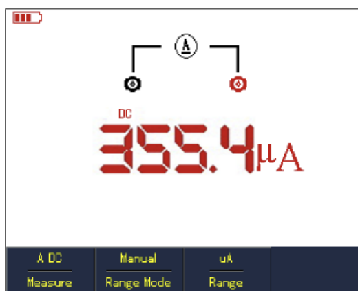
Rys. 5-7 Pomiar natężenia prądu stałego DC < 4 mA
