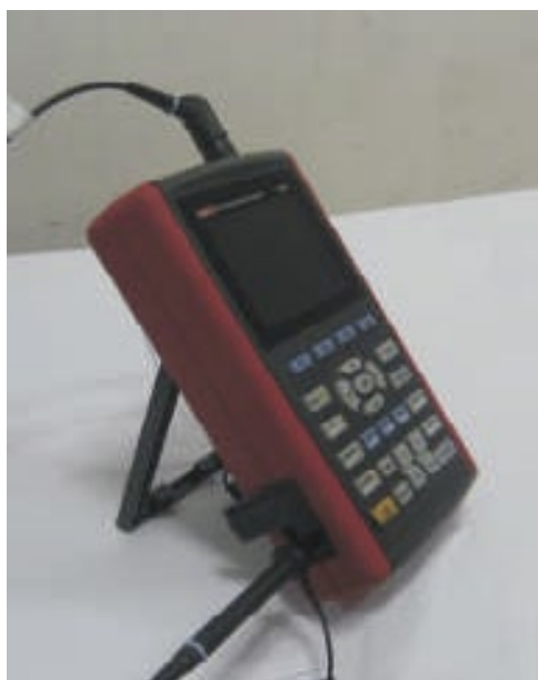
Rys. 3-2 Połączenie sondy pomiarowej w celu przeprowadzenia kompensacji
