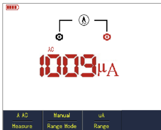
Rys. 5-17 Pomiar natężenia prądu zmiennego AC < 1 mA
