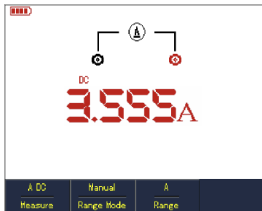
Rys. 5-9 Pomiar natężenia prądu stałego DC > 400 mA
