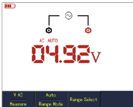
Rys. 5-6 Pomiar napięcia zmiennego AC
