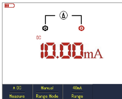
Rys. 5-14 Pomiar natężenia prądu stałego DC od 1 mA~ 40 mA
