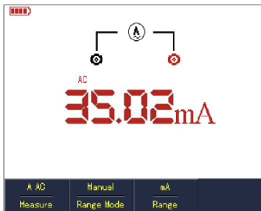
Rys. 5-11 Pomiar natężenia prądu zmiennego AC < 400 mA
