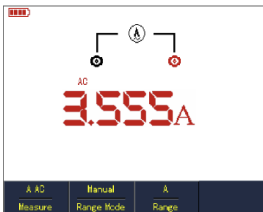
Rys. 5-12 Pomiar natężenia prądu zmiennego AC > 400 mA
