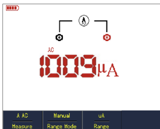
Rys. 5-10 Pomiar natężenia prądu zmiennego AC < 4 mA
