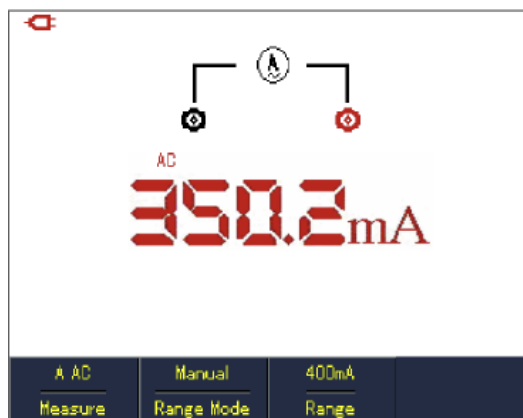
Rys. 5-19 Pomiar natężenia prądu zmiennego AC od 40 mA~ 400 mA
