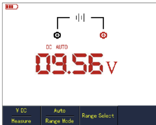
Rys. 5-5 Pomiar napięcia stałego DC
