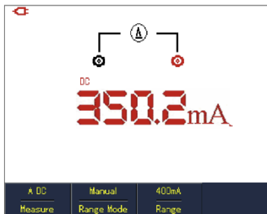
Rys. 5-15 Pomiar natężenia prądu stałego DC od 40 mA~ 400 mA
