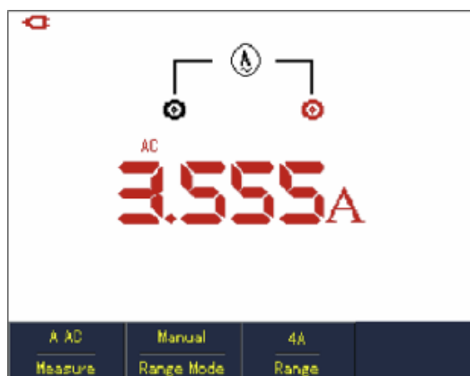
Rys. 5-20 Pomiar natężenia prądu zmiennego AC większego niż 400mA
