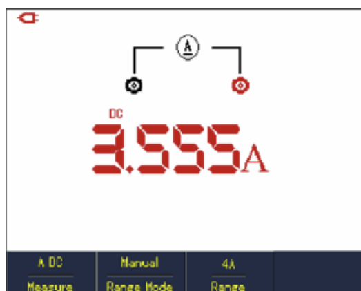
Rys. 5-16 Pomiar natężenia prądu stałego DC większego niż 400 mA
