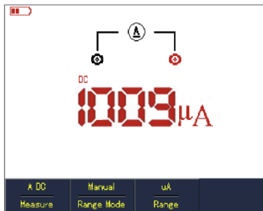
Rys. 5-13 Pomiar natężenia prądu stałego DC < 1 mA
