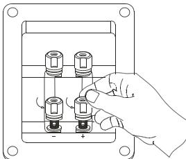
Anschlussklemme im Uhrzeigersinn anziehen, leicht am Kabel ziehen um sicherzustellen dass die Verbindung fest ist.
