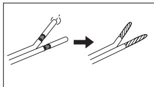
2. Rotiți terminalul în sensul acelor de ceasornic și introduceți firul dezisolat al difuzorului în orificiu.
