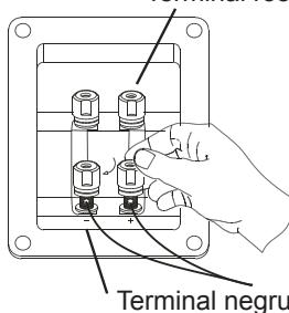
Conectați la terminalul corespunzător "+ "al amplificatorului
