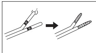
2. Anschlussklemme gegen den Uhrzeigersinn drehen und Kupferkabel in das Loch einstecken.
